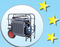
Le compresseur thermique mobile **AIRPLUS® AP50T** est équipé d'une tête de compression à piston en fonte bicylindres bi-étagée avec lubrification par barbotage et transmission par courroie.
