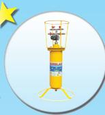
Les filtres à air NORBLAST® sont destinés à supprimer les matières telles que les huiles, mixtures, vapeurs et excès de moisissures de l'air comprimé. En utilisant un procédé de filtration multi-étages, les filtres retiennent efficacement les impuretés avec peu de chute de pression. La protection spéciale conçue par NOREXCO® évite les endommagements sur les chantiers.
