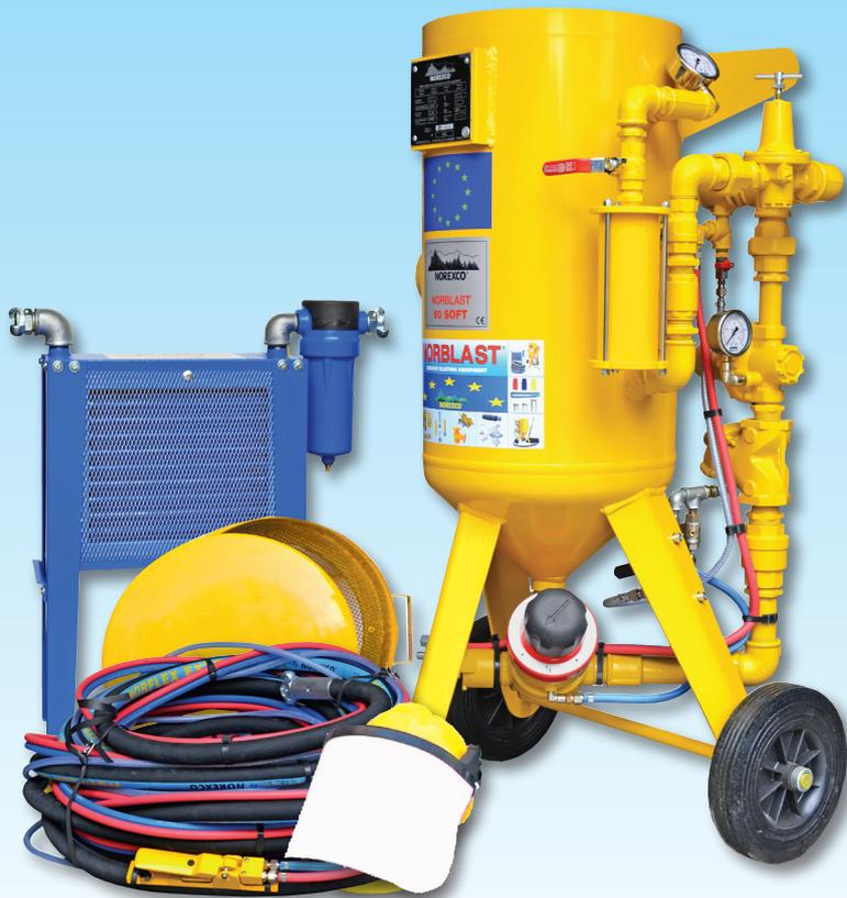
**NORBLAST® MAXISOFT® 60** est un ensemble sur lequel est installé un doseur normalement fermé, piloté par l'utilisateur à chaque mise en marche du système en actionnant la poignée de commande à distance. Une réduction très significative de la consommation d'abrasif est constatée grâce à l'utilisation de ce doseur piloté, ainsi qu'une excellente régularité du flux d'abrasif au travers du doseur. Un vibreur complète le dispositif.
